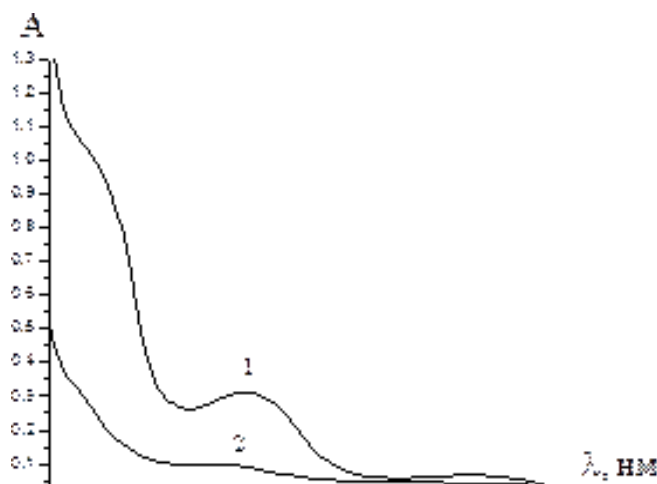
Рис 1. Спектры поглощения растворов «Silver» (1) и «Silver» с добавлением гидроксипропил- \beta -циклодекстрина (2), T = 298.2 К.
