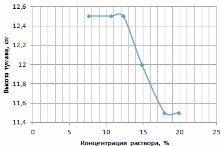
Рисунок 1 – Зависимость высоты тумана от концентрации акриловой эмульсии в растворе
