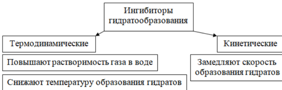
Рисунок 1 – Возможные ингибиторы гидратообразования, используемые для разных рабочих ситуаций.
